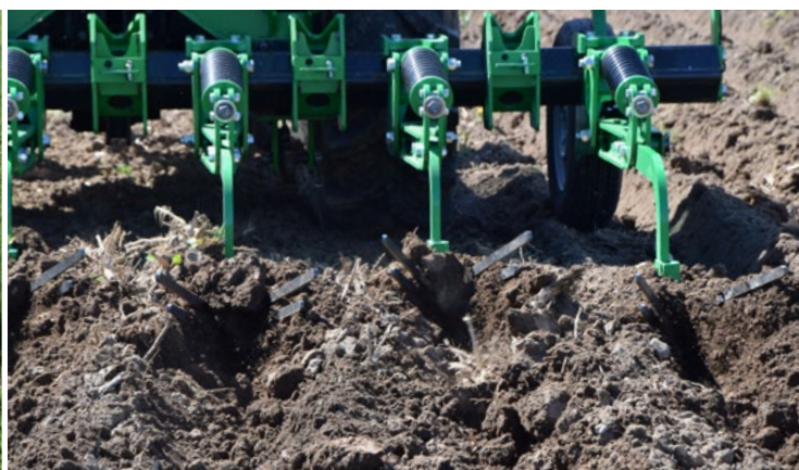
L'aratro per cumuli è dotato di protezione contro le pietre. Gli assolcatori possono essere sostituiti con elementi sarchianti.
